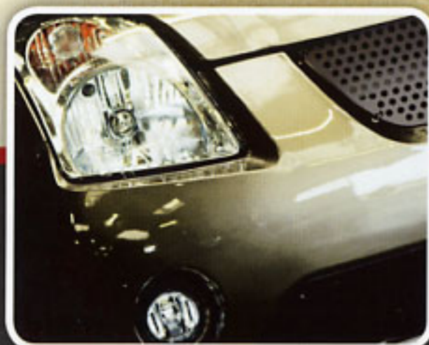
Phares halogènes et projecteurs antibrouillard intégrés au bouclier avant.
