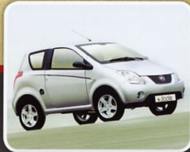
Un châssis aluminium et une carrosserie polyester.
